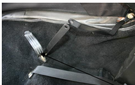
Unter der Schraube an dem die Persening befestigt wird, wird der L-Winkel befestigt
