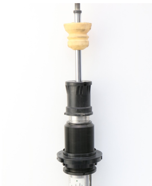
Abb. 3: Höhenverstellung, Abdeckkappe und Anschlagpuffer montieren
